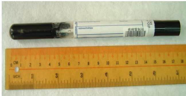
圖 2.4 侵襲性肺炎鏈球菌菌株採檢拭子。(內容物為含 Amies Agar 及活性碳之保存輸送培養基。棉棒擦拭隔夜培養之菌落後，插入輸送培養基中，於常溫 (22-35°C) 運
