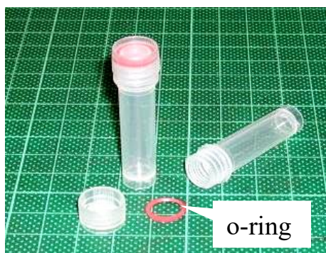
圖 2.1 檢體小瓶（透明塑膠材質，螺旋蓋內含 o-ring）。
