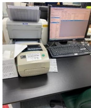
D 污染區實驗桌上電腦，無貼上生物危害警示標語。
