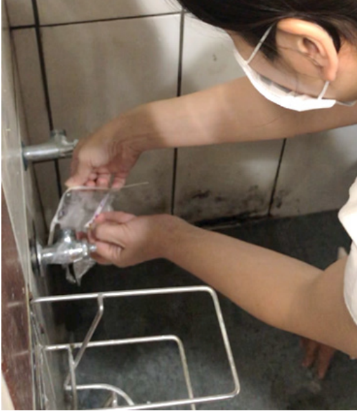
圖一 指標病室彩環境採樣，冷熱水體採樣（左）、冷熱水管壁塗抹採樣（右）
