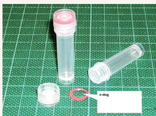
圖2.1 檢體小瓶（透明塑膠材質，螺旋蓋內含o-ring）。
