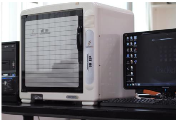
圖二、QBio 即時定量 PCR 分析儀(qRT Analyzer M6)，每次可分析 6 個晶片，40 Cycles 耗時 60-90 分鐘。
