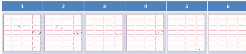
圖十一、CDC 24R-Panel Chip RSV 檢測靈敏度測試
