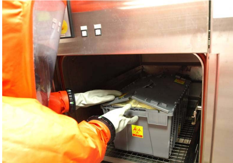
圖五、將緊急應變處理後產生的廢棄物以 134°C/20 分鐘，穿牆式高溫高壓蒸氣滅菌釜滅菌處理
