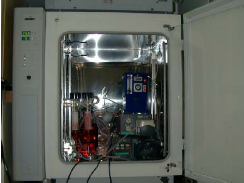
圖四、潮汐式生物反應器培養設施
