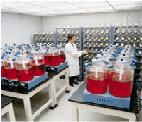
圖五、國外廠商動物細胞量產的滾動瓶(roller bottle)及攪拌瓶培養設施
