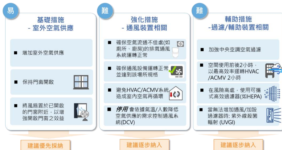
圖 61：導入防疫科技_室內空品建議改善方式
