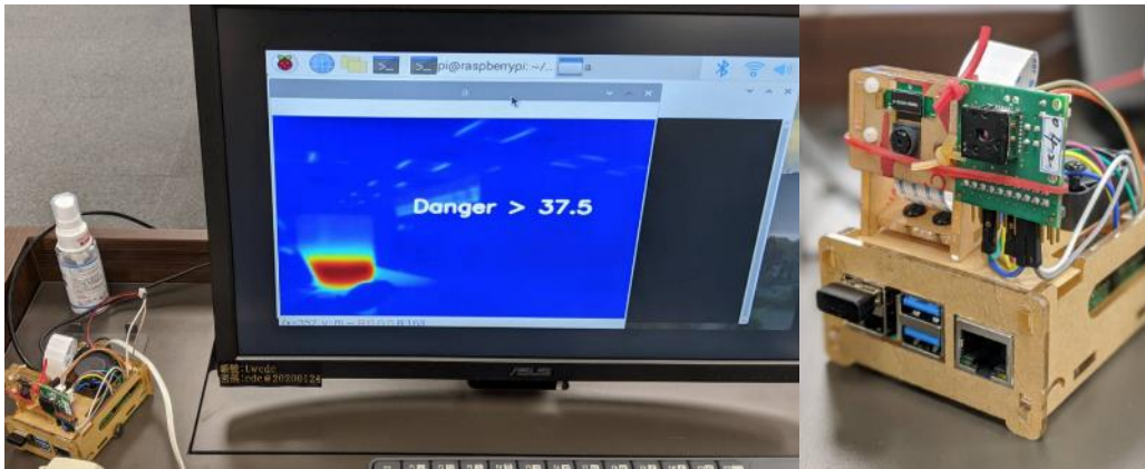
圖 67 簡易型紅外線體溫監測儀
