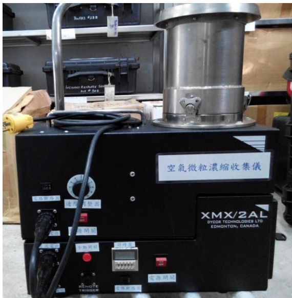
圖1、空氣微粒濃縮收集器-型號 XMX-2A/2AL(DYCOR, Canada).
