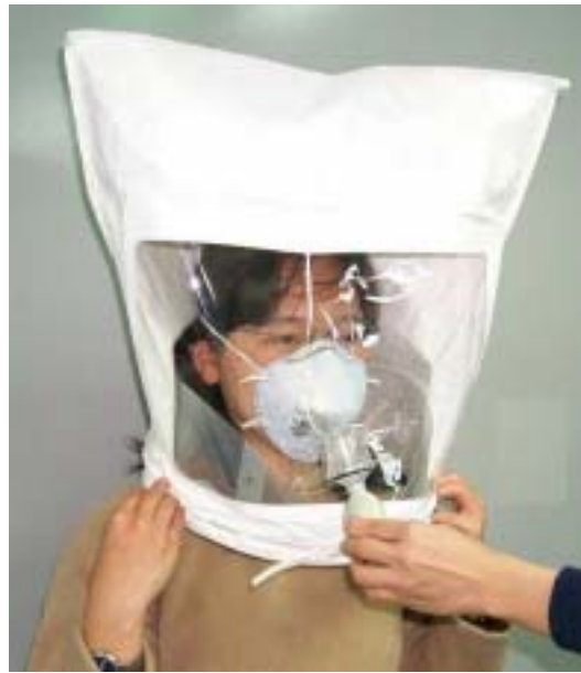
圖3 實際進行糖精定性密合度測試情形。
