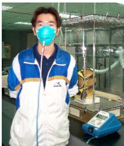
圖4 使用TSI PortaCount進行密合度測試。
