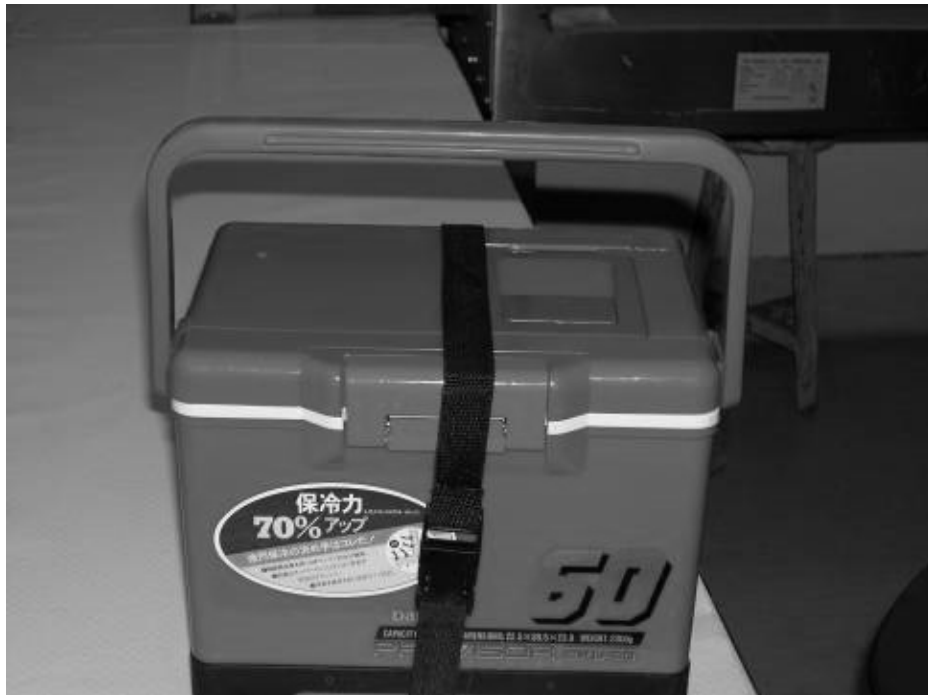
圖 2-11：檢體運送箱確認封妥（溫度控制於 2-8℃）
