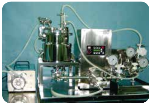
圖 76 破傷風類毒素匣式過濾濃縮透析系統 (Kvick Flow)
