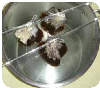
圖 75 棉線綁妥的透析袋，需要每日換水約 7 \pm 2 天，才能完全移除硫酸銨
