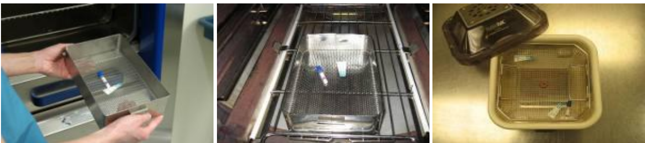
圖六：270-275°F/132-135°C 快消式高壓蒸氣滅菌鍋的 PCD 包
