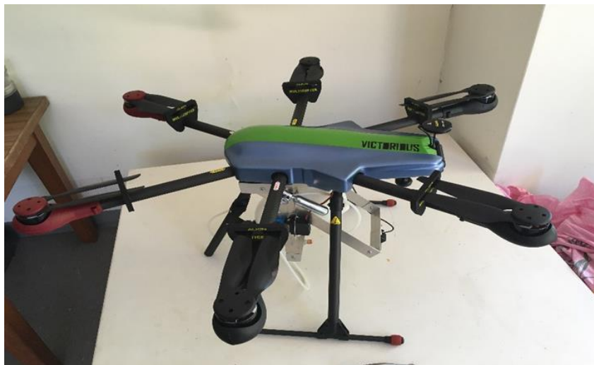
圖六 針對病媒蚊成蚊防治設計之多軸無人超低容量煙霧機(ULV)。
