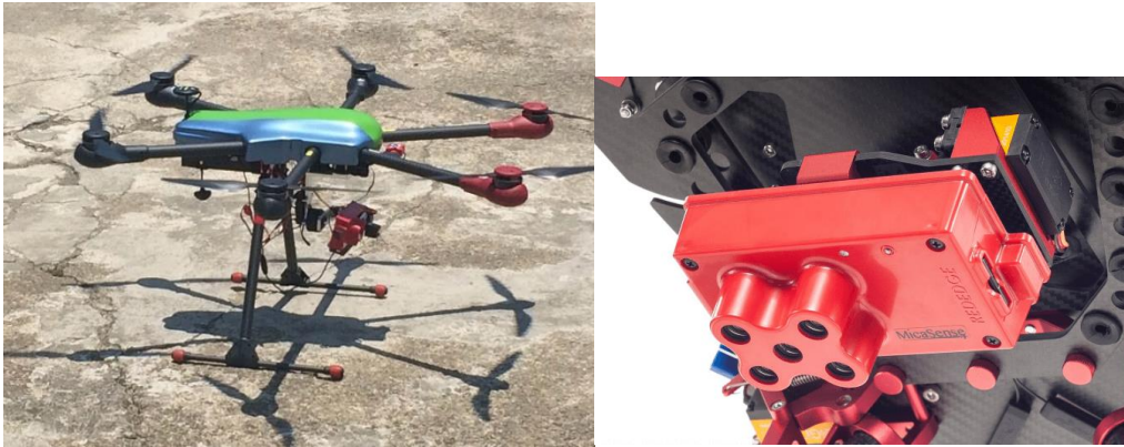
圖三 多軸無人飛行載具 (UAV) 搭載輕量化多光譜相機 (右圖)。
