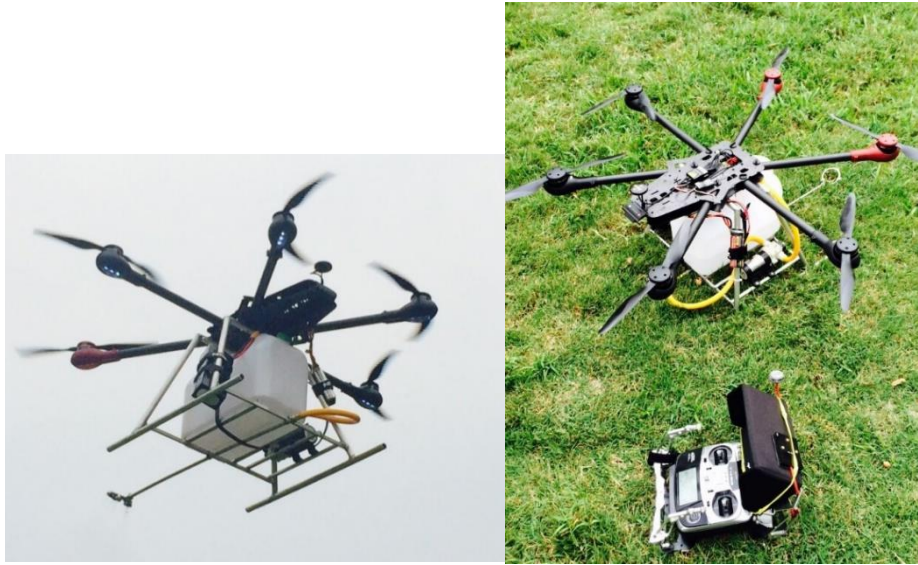
圖五 病媒蚊成蚊與幼蟲防治設計之多軸無人液態撒藥機。
