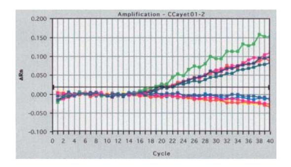
圖 1、運用及時聚合酵素連鎖反應方法偵測環孢子蟲 18S rRNA 片段的激增圖表。黑線表示此一實驗結果的臨界值,係依據實驗中的無模板控制組的結果而定。無模板控制組是以藍色、深藍色及粉紅色顯示並且位於臨界值的下方。臨床病人糞便檢體萃取之核醣核酸經過 20 個循環之後開始產生顯著的差異,其中 5 個檢體的ΔRn 值逐漸上升且高於臨界值,另外 2 個檢體 〔紅色及黃色〕仍然與無模板控制組一樣低於臨界值。
