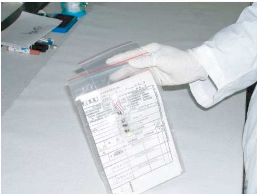
圖 2-4、將裝有檢體的內層夾鏈袋放入外層夾鏈袋並密封妥
