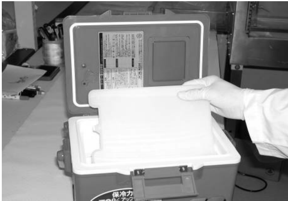
圖 2-9：將保冷劑放置於檢體運送箱中
