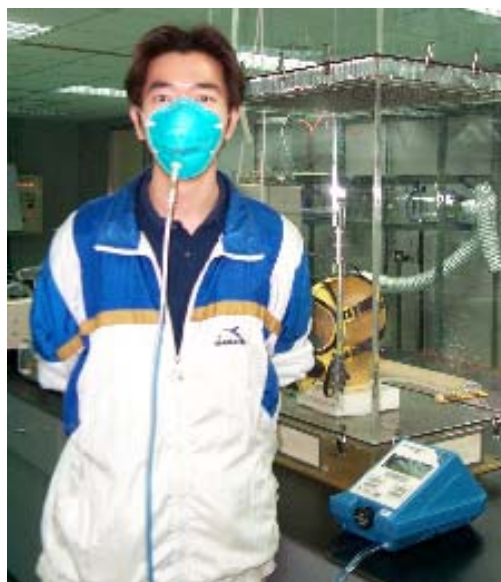
圖4 使用TSI PortaCount進行密合度測試。
