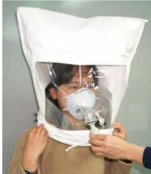
圖3 實際進行糖精定性密合度測試情形。
