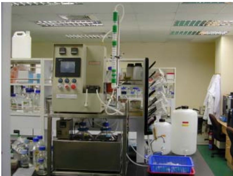
圖十二、第三代全自動膠體清洗機，可由電腦控制清洗液種類(兩種選擇)、清洗液量、流速、循環時間、循環次數與排水等功能。
