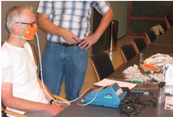
圖 1 呼吸防護具防護效能及密合度測試 (van der Sande et al., 2008)
