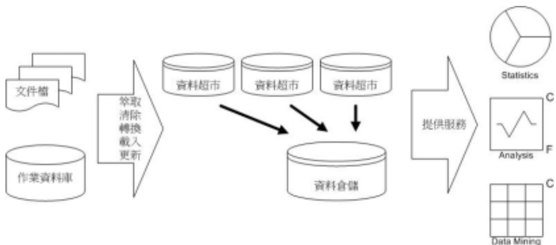
圖五、混合漸進式資料倉儲建置架構
