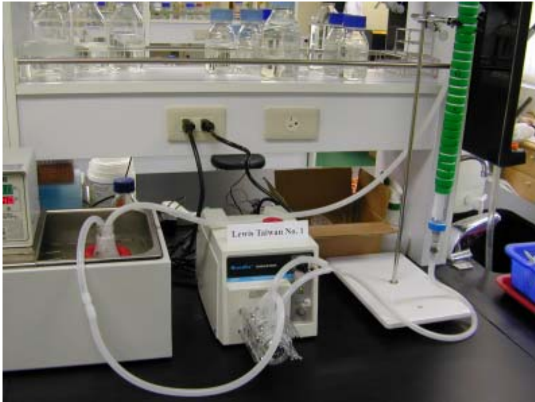
圖八：Lewis Taiwan No. 1 膠體清洗機，一次可清洗 30 以上樣本，縮短清洗時間由原需 4 小時至 1 小時，得到之 DNA 品質優於手工方法清洗者。
