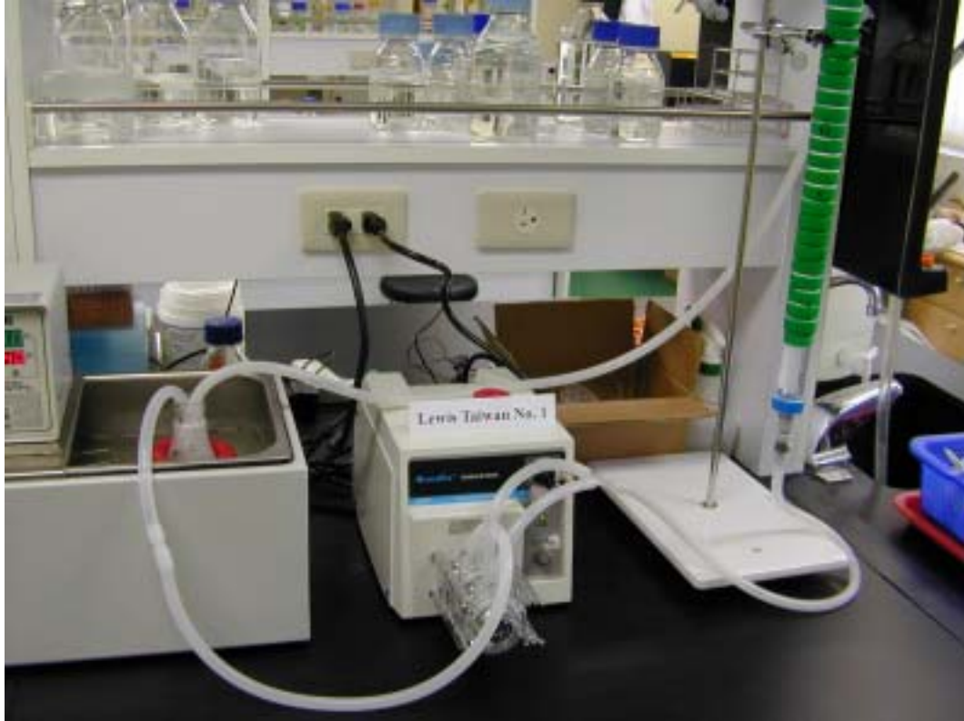
圖二：Lewis Taiwan No. 1 膠塊清洗機，由實驗室自行組製，一次可清洗 30 個以上樣本，清洗時間由原需 4 小時縮短至 1 小時，也增加處理樣本數的能力，得到之 DNA 品質優於手工方法清洗者。
